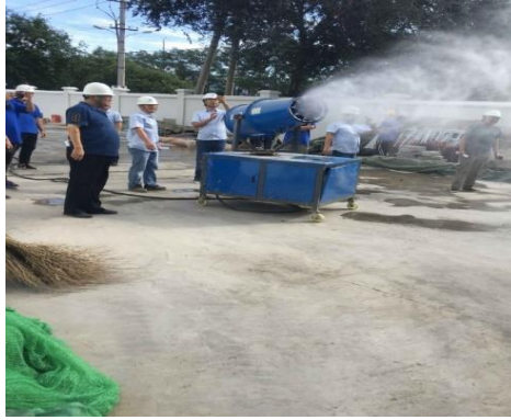
图 6.2-1 围挡现场放置雾炮机进行除尘
